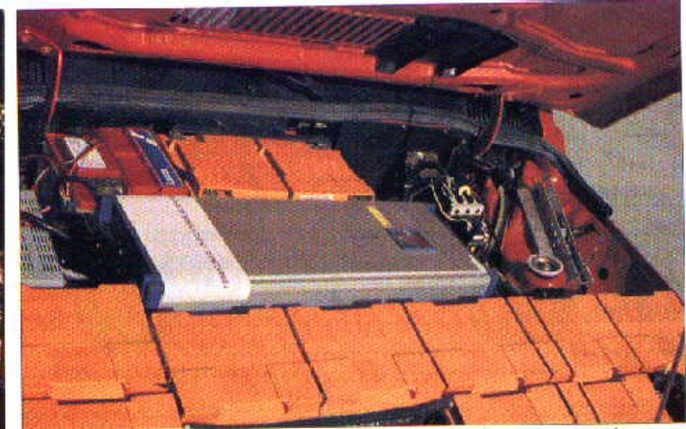
Το σύστημα συσσωρευτών και ο ενσωματωμένος φορτιστής των συσσωρευτών
